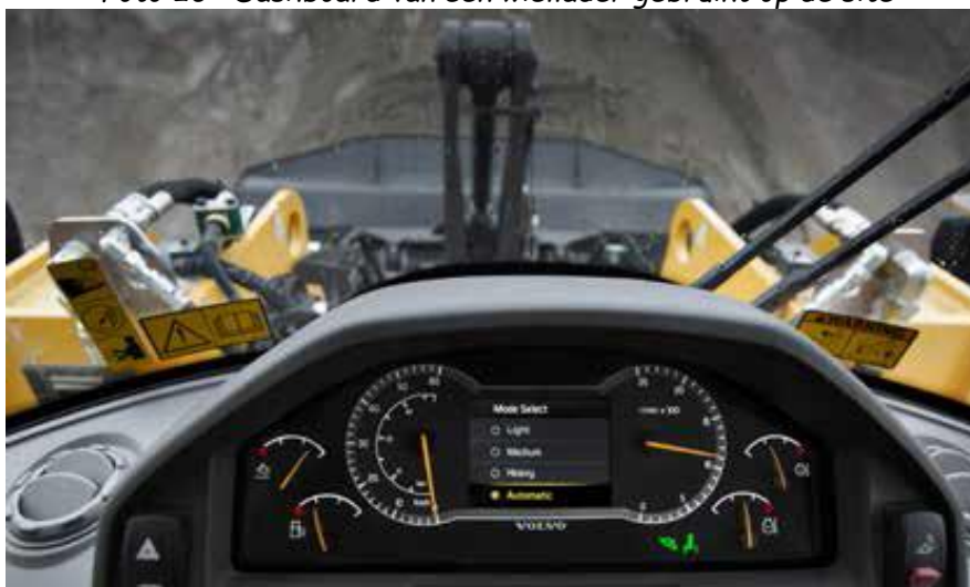
Foto 20 : Dashboard van een wiellader gebruikt op de site
